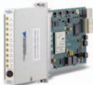
NI FlexRIO 製品にはFPGA モジュールとI/O アダプタモジュールがあり、NI LabVIEW FPGA 用のカスタマイズできる柔軟なI/Oを提供します。FPGA とアダプタモジュールで構築する高性能な再構成可能計測器は、LabVIEW FPGAモジュールを使ってプログラミングします。NI FlexRIO アダプタモジュール開発キット (MDK) を使用すると、お客様のアプリケーションに必要なコンバータ、バッファ、クロック、コネクタを搭載した計測器を設計することができます。
