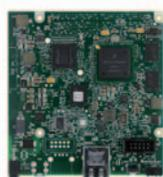
NI Single-Board RIO 製品は、NI CompactRIO をベースにした低コスト実装ソリューションです。リアルタイムプロセッサ、再構成可能FPGA、アナログ/デジタルI/Oを1つのボードに組み込み、NI LabVIEW Real-Time およびLabVIEW FPGA 技術を利用して動作します。
