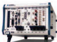
PXI-6653/PXI-6652 (タイミング/同期制御モジュール) は、PXIのトリガバス、スタートリガ、およびシステム基準クロック機能を使用して、高度なマルチデバイスまたはマルチチャージ同期を実装します。LabVIEW FPGAモジュールは、NI PXI-6653/2モジュール上にあるFPGAをターゲットとし、ユーザ定義によるカスタム仕様のアプリケーションを開発するのに役立ちます。こうして開発されるアプリケーションとしては、タイミング/同期、カスタムトリガ、高速アナログカウンタなどがあり、これらは市販のハードウェアでは実現不可能なものでした。
